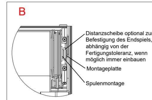
Die Wandplatte kann gebogen werden, um eine nicht-parallele Laibungsbefestigung zu ermöglichen. Die Wandplatte kann bis zu 6 mm pro Seite gebogen werden, ohne dass dies Auswirkungen auf die Installation und den Betrieb des Systems hat. es ist wichtig, die schmalste Stelle der Laibung zu finden und zu bestellen die passende Systemgröße sw entspricht dem Befestigungsmaß minus 12mm wenn die Laibung um mehr als 12 mm abweicht, ist eine Verpackung erforderlich
